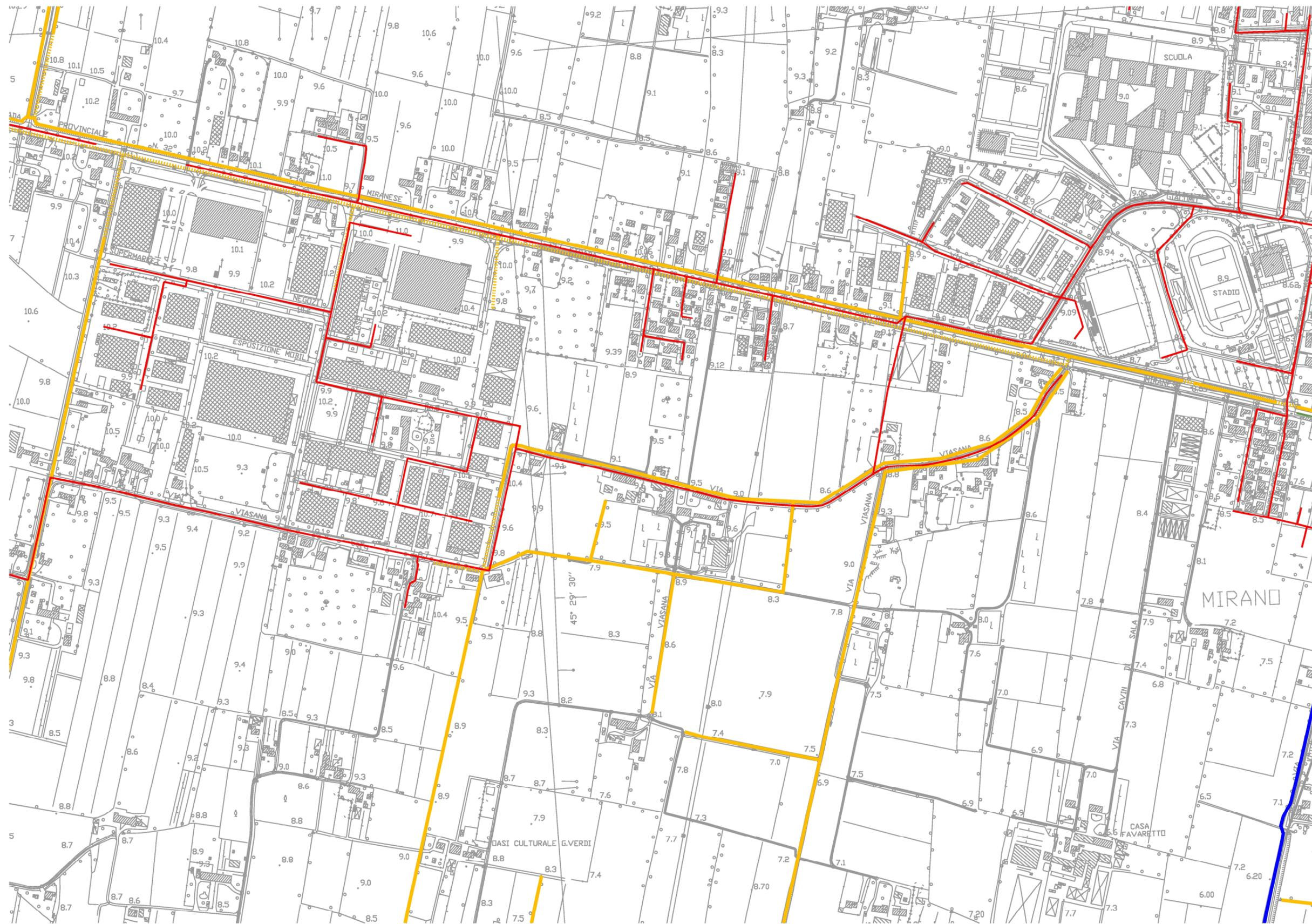
Figura 8 - Fognatura Nera ubicata nei pressi della Via Cavin Di Sala
